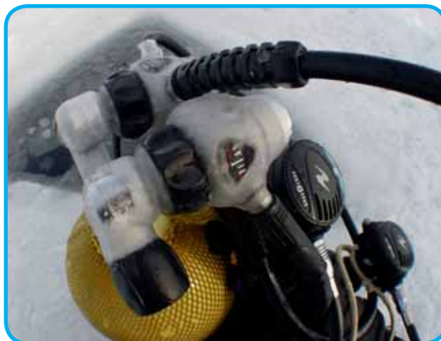
Mořská voda zamrzá při teplotě okolo -1,7 °C. Po ponoru v extrémně nízkých teplotách bývají oba první stupně i ventily obalené ledem.
